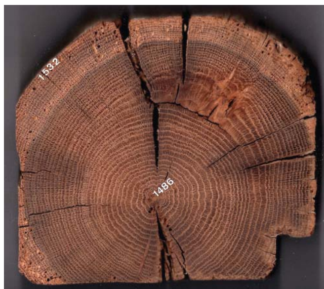
Figure 9 – Échantillon dendrochronologique (869/01/013) prélevé dans un seuil de fenêtre avec trace de la feuillure périphérique (section : 18 x 15 cm).
