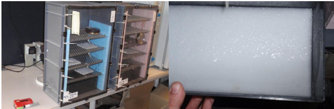
Figure 89: Caissons étanches (a) et solution saline saturée (b)
