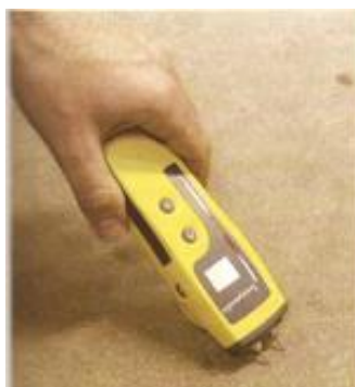
Figure 12: Mesure par résistivité électrique (Howard M.K., 2005)
