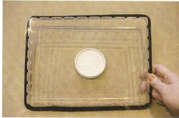
Figure 8: Test au chlorure de calcium (Howard M.K., 2005)
