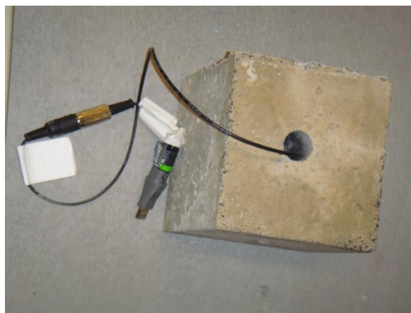
Figure 122: Influence de l'humidité introduite par forage
