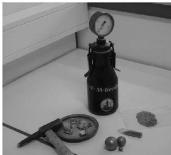
Figure 7: Bombe à carbure (Courard L., 2011b)
