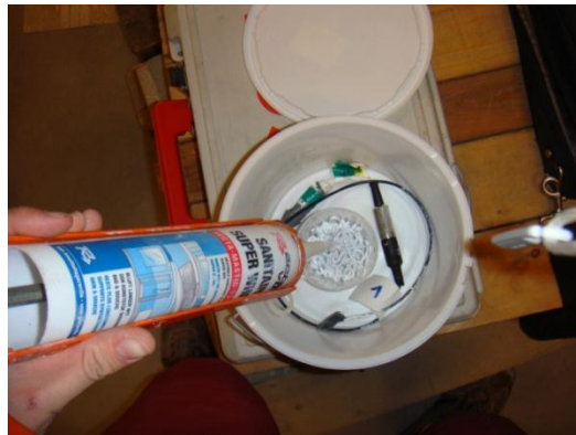
Figure 120: Illustration du test de l'influence du silicone sur les capteurs
