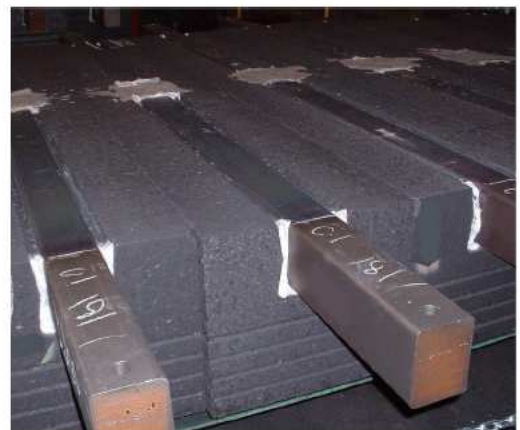
(b) Scellement des barres collectrices
