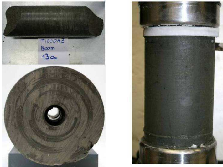
Figure 115: Echantillon cylindrique d'Argile de Boom utilisé lors de ces expériences (TIMODAZ, 2010c)
