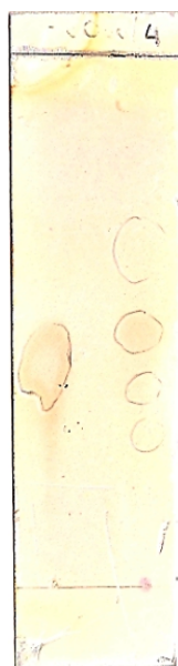
Figure 42 : CCM d'un standard d'alliine (gauche) et d'un extrait d'ail (droite) sur C18, phase mobile MeOH/AcOEt/H 2 O (5/4/1). Les spots révélés à la ninhydrine sont légèrement effacés.
