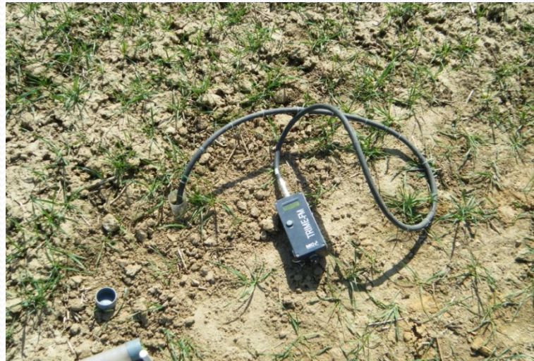
Mesure manuelle d'un profil d'humidité avec la sonde Trime-FM
