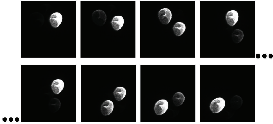
FIG. 4.3 – Evolution en intensité, orientation et position des faisceaux émergents de la lame lors d'une rotation de 180^\circ de cette dernière autour de l'axe optique et pour un faisceau incident polarisé linéairement TM.
