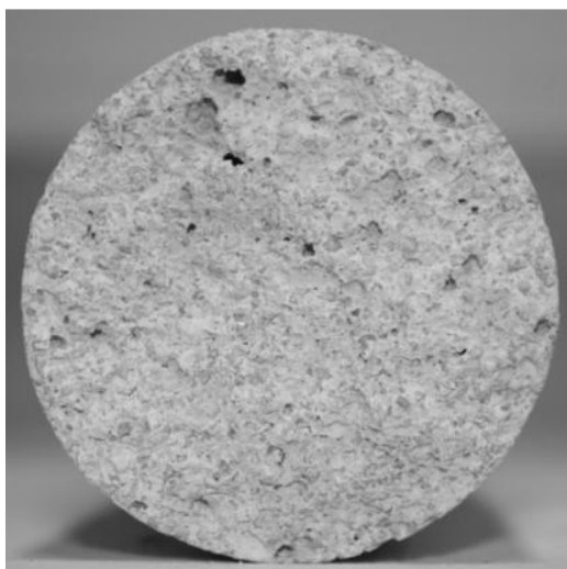
Figure 14. Face intérieure (contre le vide la séparant du béton) de l'échantillon en Pierre armée Pauchot présenté à la figure 13.
