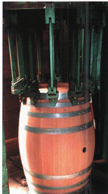
Pose des cerceaux définitifs.
