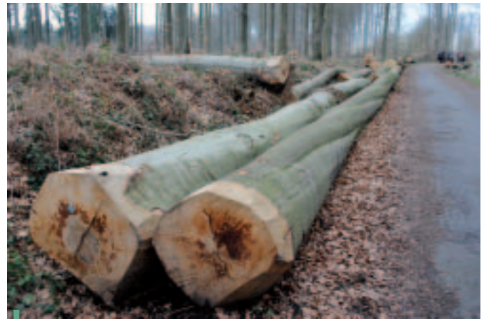
Fibre torse sur hêtre
