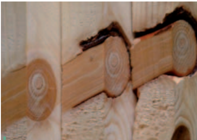
Types de nœuds : du nœud vivant au nœud mort
