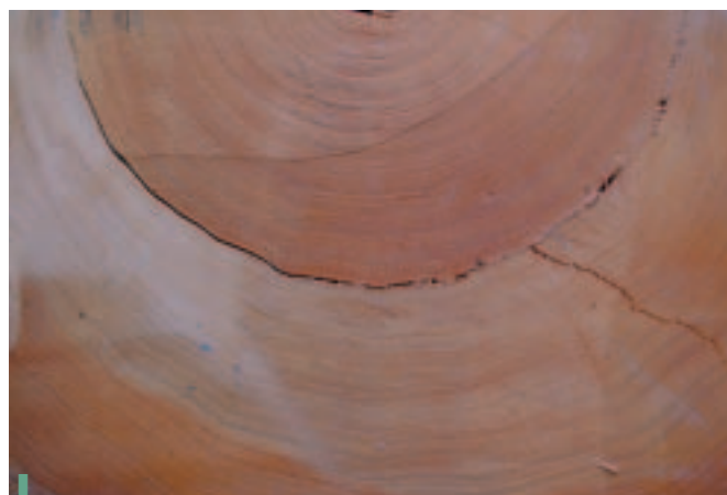
Roulure sur coupe transversale.
