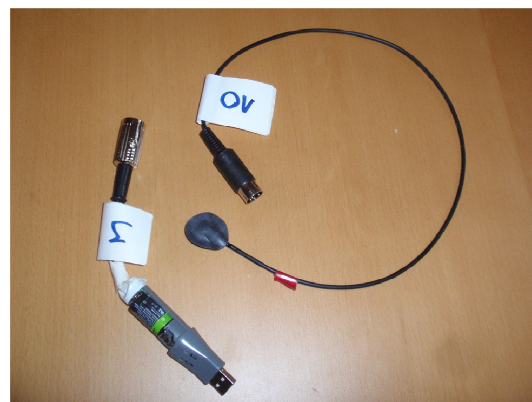
Capteur hygrométrique modifié pour être utilisé dans le béton
