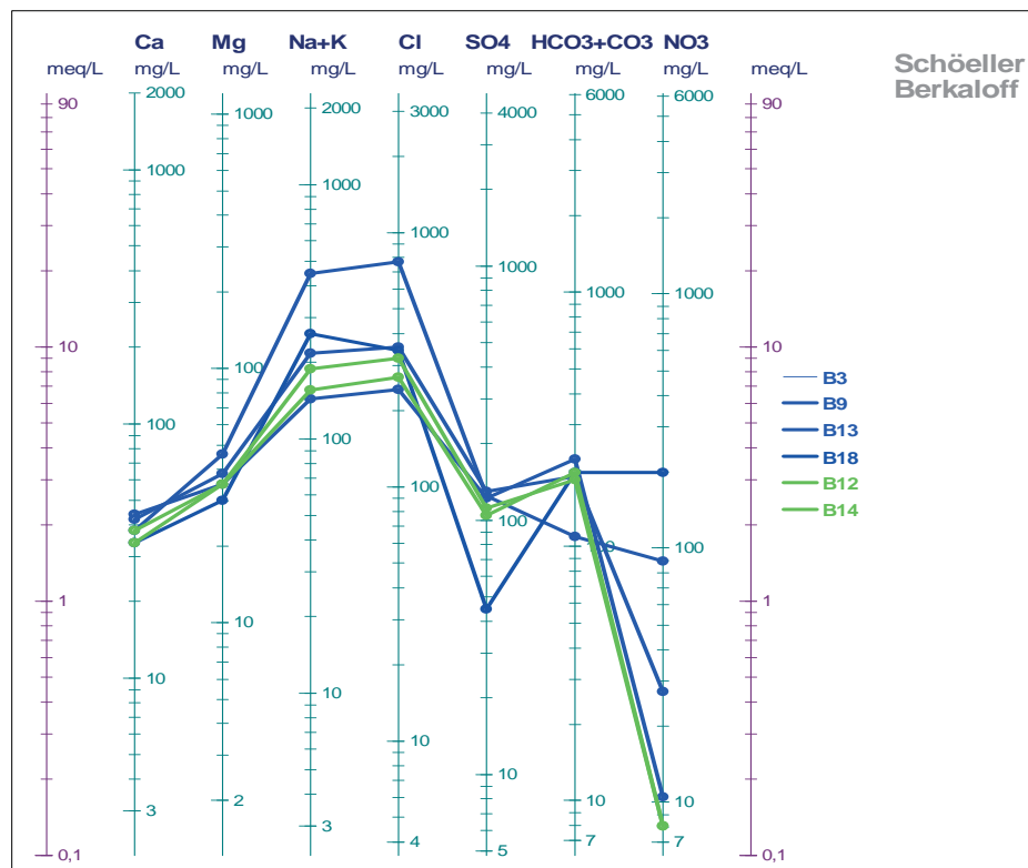
Figure 8. Facies chimiques des eaux Plio-Quaternaires (B3, B9, B13et B18) et Turoniennes (B12 et B14) (compagne d'octobre 2009)
