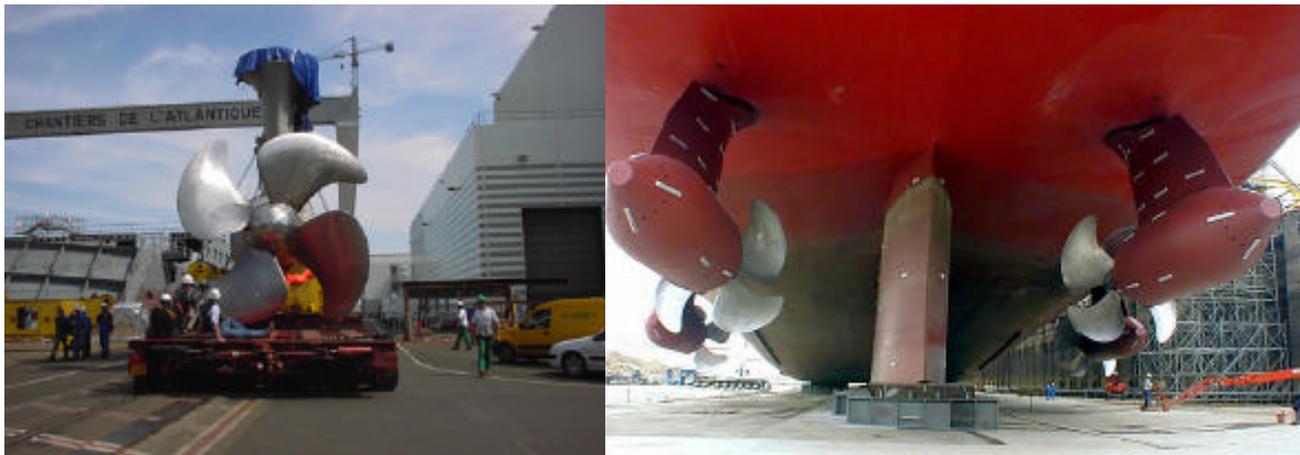
Le système de propulsion par PODS - Source photo: Alstom(2)
