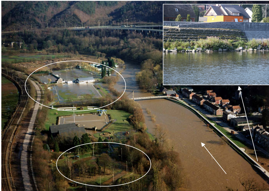
Figure 74 : Principales zones inondées aux Prés de Tilff et murs anti-crues en rive droite.
