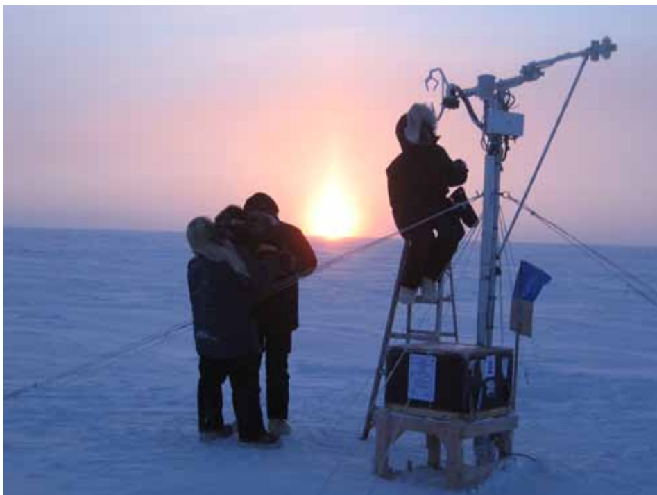
Nous informons Nok, notre guide Esquimau, sur le fonctionnement de notre système de mesure pour qu'il puisse en faire la maintenance. En arrière-plan, une superbe parhélie
