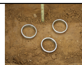
Fig. 6. Prélèvement d'échantillons oedométriques
