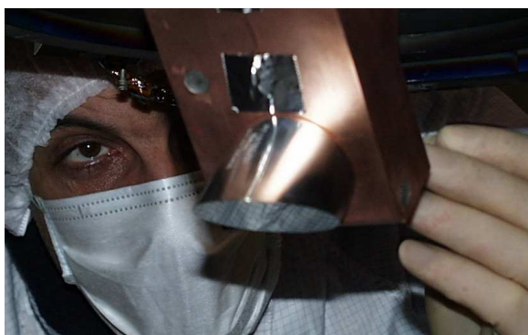
Figure 6.11. Miroir en aluminium recouvert d'une couche de nickel déposée par pulvérisation par faisceau d'ions. Le miroir est fixé à un bloc de cuivre refroidi par eau.
