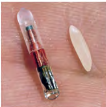
Photo 5 : Pit-tag classique (marque individuelle passive) et lecteur manuel
