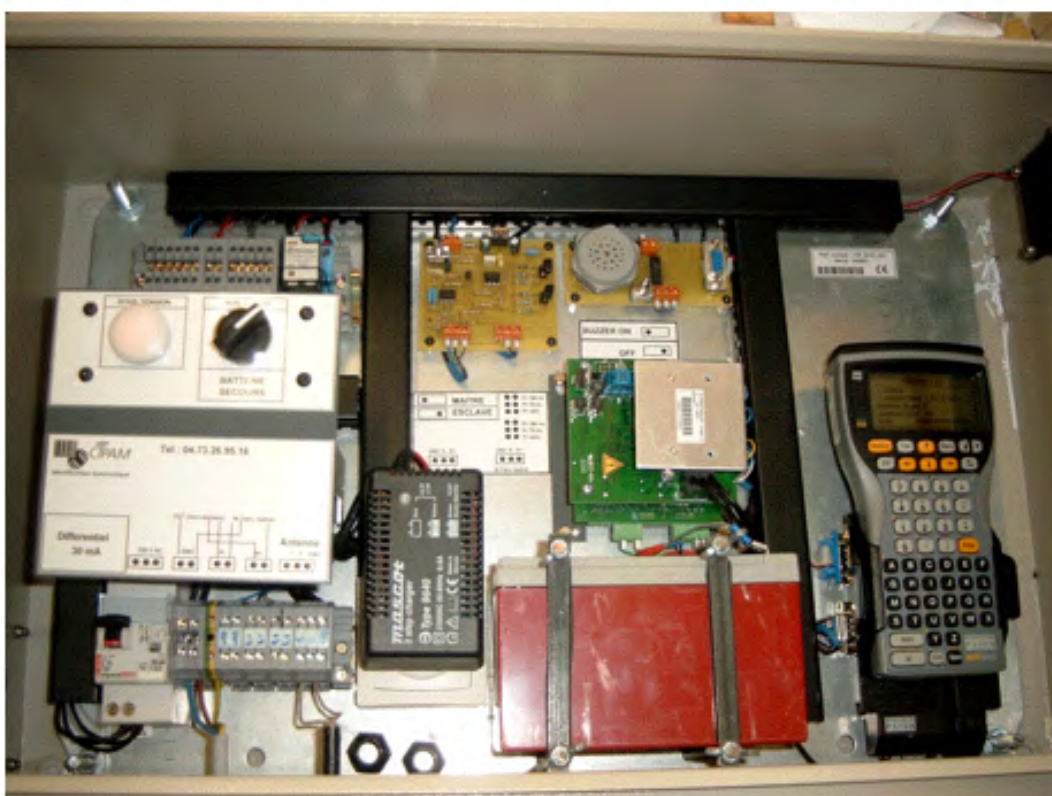
Planche photos 7 : En haut : vue de l'antenne de détection CIPAM placée dans le dernier bassin amont, juste avant la cage de capture. En bas : boîtier électronique de détection CIPAM placé dans le chalet en bois.
