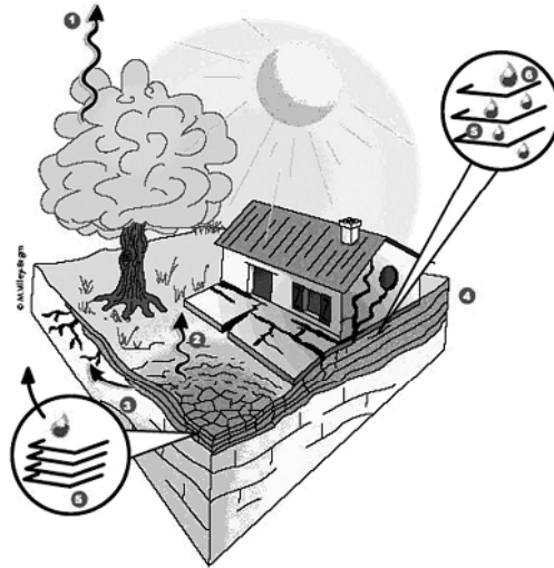
Figure 1-5 : Effet de la modification de la teneur en eau dans des terrains argileux ( www.argiles.fr )
