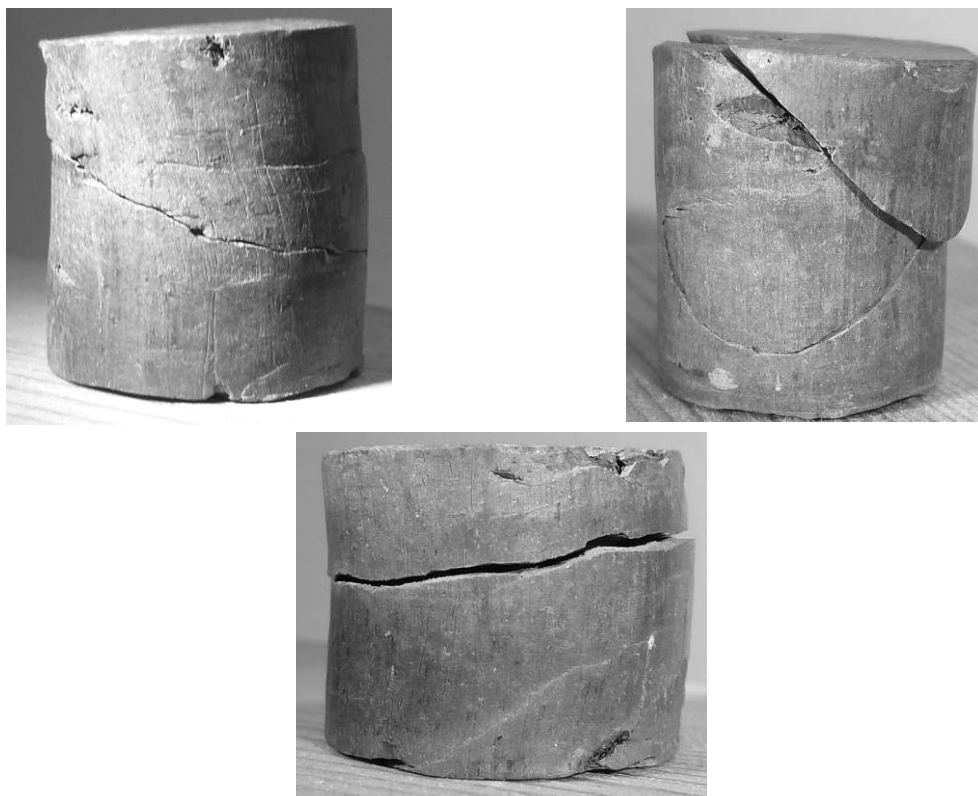
Figure 5-14 : Observations macroscopiques de fissuration sur des échantillons d'argile de Boom soumis à désaturation
