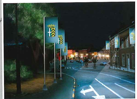
▲ Proposition de mise en lumière pour la porte de Neufville à Soignies. Trois oriflammes implantés de part et d'autre de la rue créent un effet de porte. Elles sont éclairées par une lumière rasante à LED. Les arbres sont mis en lumière par un éclairage en contre plongée. Des projecteurs équipés de grilles de défilement sont fixés sous la corniche pour renforcer l'éclairage de la voirie jusqu'au carrefour.
