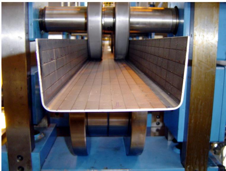
FIGURE 6.18 – Profil à la sortie de la dernière tête. La tôle a été tramée pour faciliter les mesures de forme.
