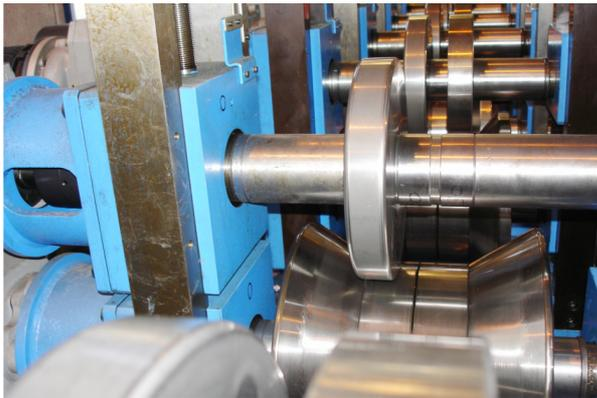
FIGURE 6.47 – Suppression d'un galet pour provoquer un défaut de symétrie dans le profil.
