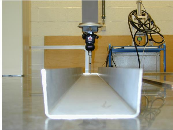
FIGURE 6.27 – Échantillonnage de la surface interne du profilé par un système d'acquisition 3D de haute précision.
