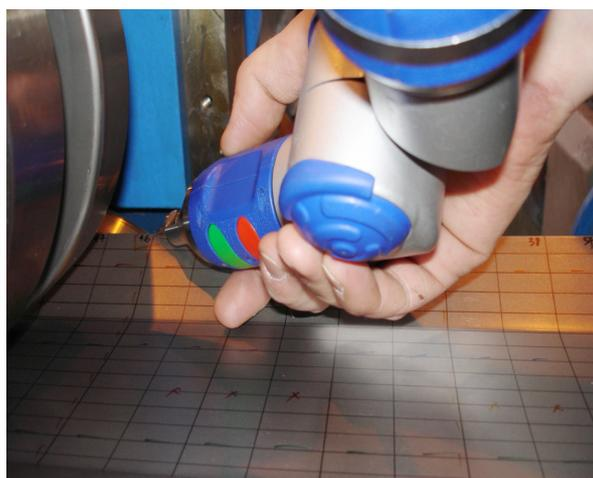
FIGURE 6.26 – Mesure de la géométrie d'une section. L'acquisition se fait manuellement sur une grille préalablement tracée sur la surface supérieure de la tôle.
