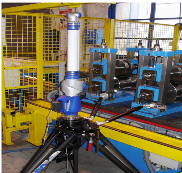
FIGURE 6.25 – Bras de mesure 3D articulé fixé à la ligne pilote. Ce dispositif permet de mesurer à tout instant la position 3D ( $x$ ,  $y$ ,  $z$ ) de son extrémité.
