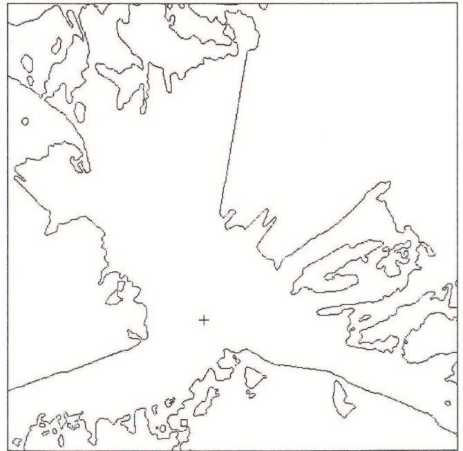
FIGURE 12. Limite du champ de visibilité obtenue par filtrage (filtre de Roberts) du masque apparaissant à la figure 11. Le point de vue est indiqué par une croix dans l'image.
