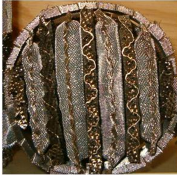
FIGURE 2.7: Vue du haut d'un élément de Katapak-SP11
