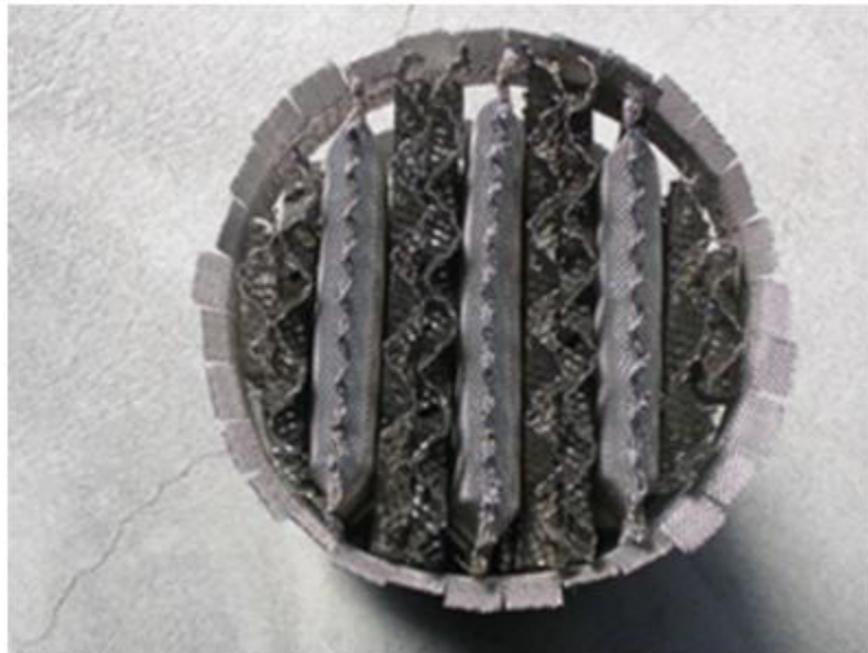
FIGURE 2.5: Vue de haut d'un élément de Katapak-SP12
