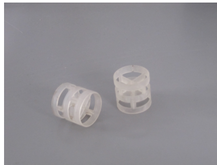
FIGURE 2.4: Photo d'un empilage aléatoire : le Pall ring
