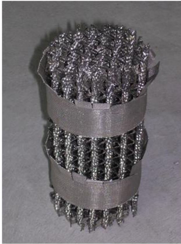
FIGURE 2.2: Photographie du Mellapak Plus 752Y
