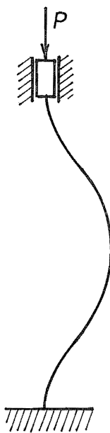
FIGURE 15.11 – Flambage d'une poutre bi-encastée.
