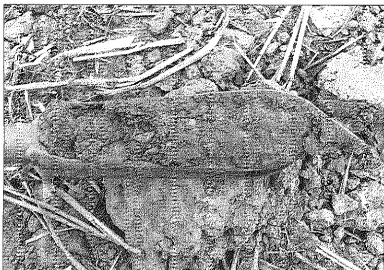
La tarière permet d'observer le sol jusqu'à 125 cm par « carottes » de 10 cm. En un point donné, c'est ainsi plus de 10 carottes qui sont extraites pour observation.
