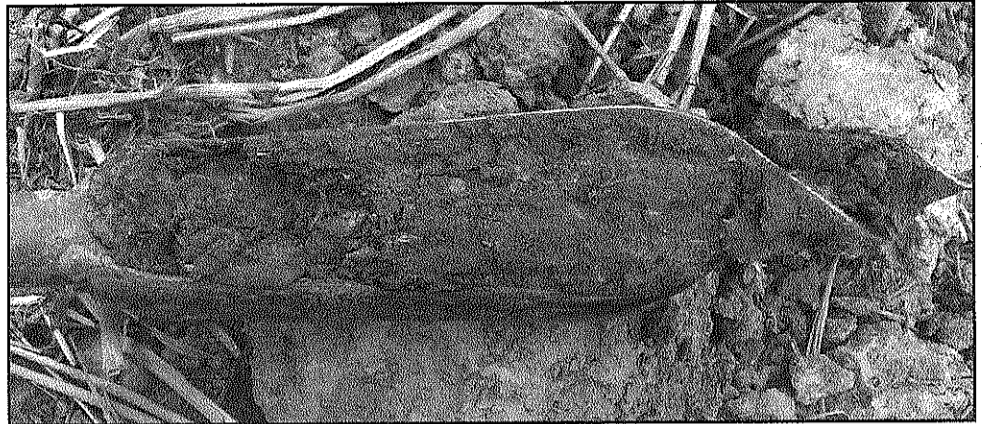
La tarière permet d'observer le sol jusqu'à 125 cm par «carottes» de 10 cm. En un point donné, c'est ainsi plus de 10 carottes qui sont extraites pour observation
