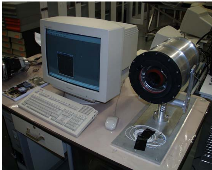
Figure 4. La console du système de vidéogrammétrie de l'ESTEC avec un canister
