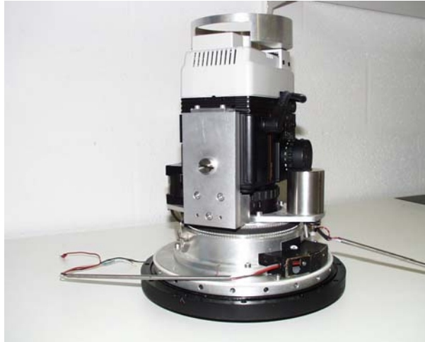
Figure 3. La caméra Rollei montée sur bloc rotatif
