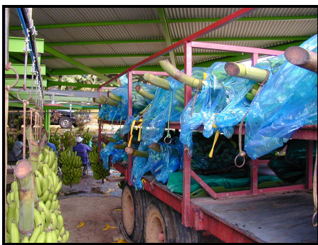
Figure 10a : Remorque bi-étagée avec berceaux matelassés utilisée lors de la récolte.
