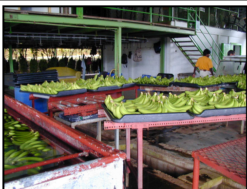
Figure 10g : Disposition des bouquets dans des bacs déposés sur des tapis roulants.
