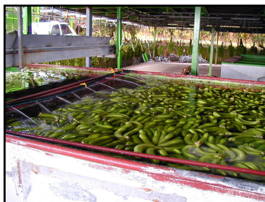
Figure 10f : Le trempage dans les bains de délatexage.
