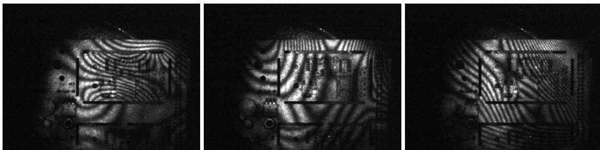
Figure 5. Modes de vibration d'un circuit électronique excité par shaker.
