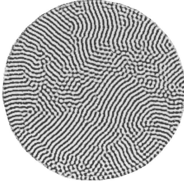
FIG. 6.1 – Exemple de l'instabilité de Küppers-Lortz. Pattern obtenu dans du  $CO_2$  à la pression de 32 bars d'après Hu et al. [Hu et al., 1998].
