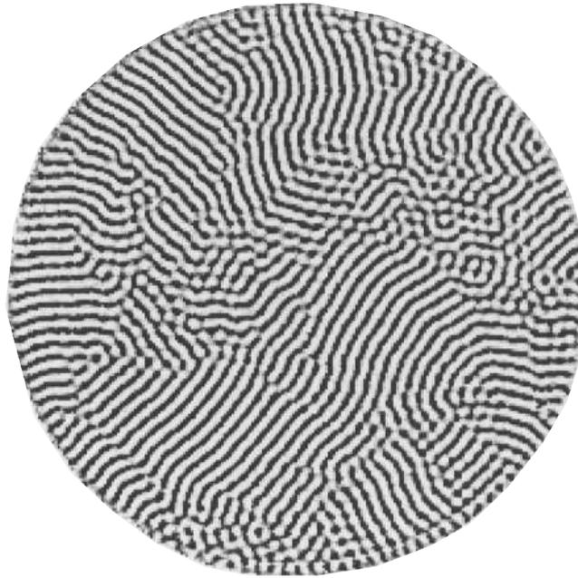
FIG. 5 – Exemple de l'instabilité de Küppers-Lortz. Pattern obtenu dans du  $CO_2$  à la pression de 32 bars d'après Hu et al. [Hu et al., 1998].
