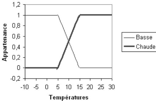
Fig. 3 : Fonctions d'appartenance pour la température
