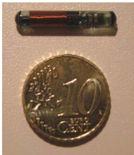
Figure 1. Transpondeur TIRIS Texas Instrument pour utilisation avec boîtier de détection CIPAM®
