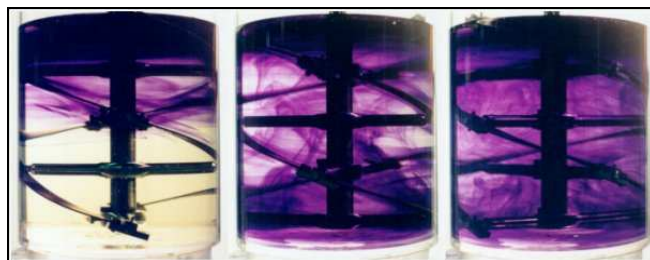
Figure 6 : répartition d'un colorant dans une cuve agitée pour l'estimation du temps de mélange [10]
