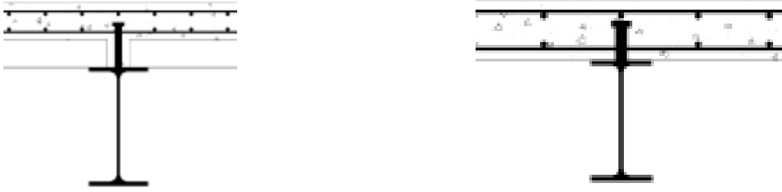
Figure 12.7. L'armature de dalle est placée sous le niveau des têtes de connecteurs. A droite, dalle sur bacs acier. A gauche, dalle coulée sur coffrage traditionnel.
