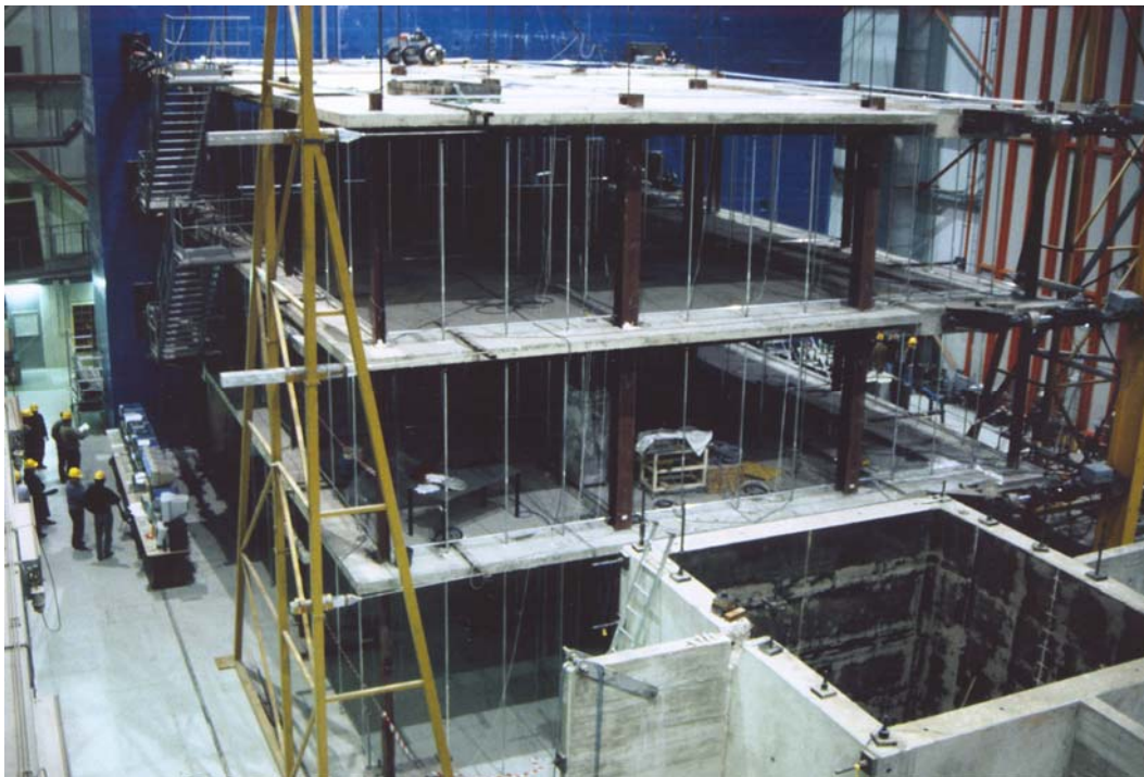
Figure 12.10. Essai en vraie grandeur sur ossature mixte en portique exécuté au CCR Ispra (I). (Plumier&Donoux, 2001).
