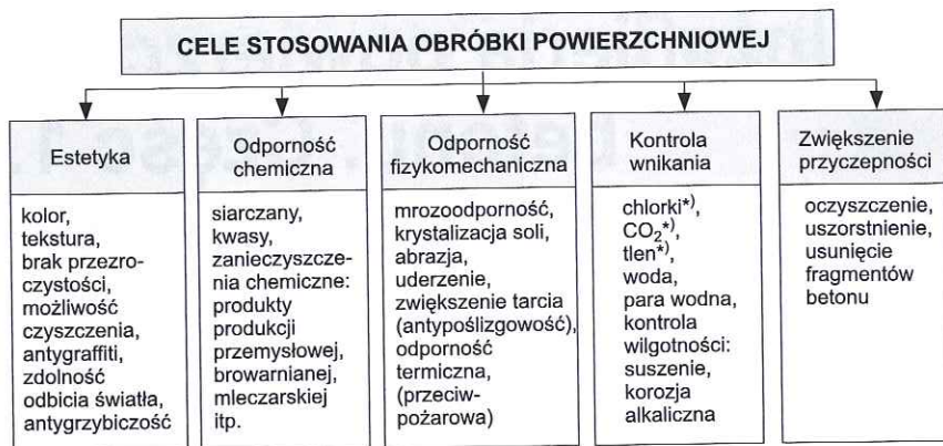
Rys. 1. Cele stosowania obróbki powierzchniowej wg PN-EN 1504-10 i ACI Concrete Repair Manual
