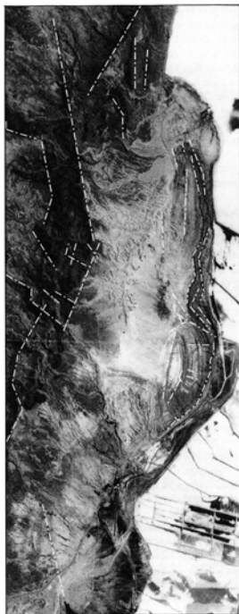
Photo 1. Failles et linéaments principaux
