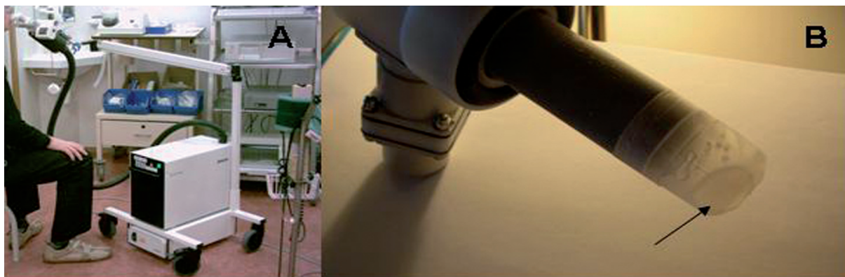
Figure 2. Appareil EcoScreen® (A) constitué d'un générateur qui refroidit à -20^{\circ}\text{C} le condensateur en aluminium, à la partie inférieure duquel est fixée une cupule en polypropylène où est recueilli le condensat d'air exhalé (B).
