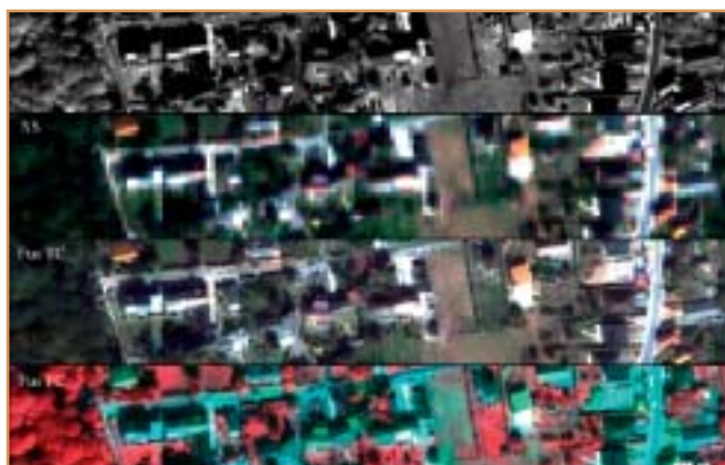
Figure 2 : Fusion du panchromatique (ligne 1) avec le multispectral (ligne 2) en vrai couleur (ligne 3) ou en infrarouge fausse couleur (ligne 4)
