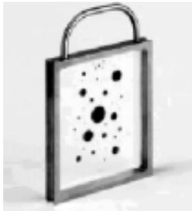
**Figura 5** Mira de calibración de un videogranulómetro en caída libre (doc. Retsch)
