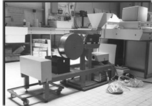
**Figura 2** El sistema Sysmex creado por Malvern, cubre una gama granulométrica de 0.7 a 40  $\mu\text{m}$  ó de 4 a 160  $\mu\text{m}$ . Las partículas son puestas en suspensión dentro un fluido con el fin de controlar mejor su posición dentro el campo de visión de la cámara (doc. Malvern).
