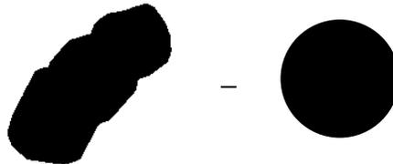
**Figura 6** Para calcular la superficie proyectada de un grano se debe contar el número de píxeles incluidos. Esta mensura de superficie es convertida por la mayoría de los sistemas en un diámetro de disco equivalente.
