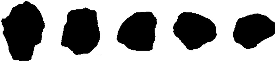
Figura 10 . Ilustración de algunos granos que provienen de la misma muestra de arena y corresponden a un índice de abrasión creciente: 36 % ; 39 % ; 47% ; 58% y 63 %.
