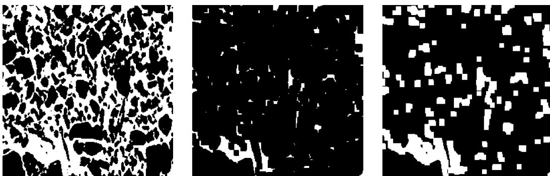
Fig.I_16. L'image de la microporosité d'une roche réservoir (craie) avant et après érosion par un carré de 10 pixels. Seules les porosités de taille supérieure résistent à l'opération. L'opération d'ouverture s'obtient en appliquant une dilatation au résultat de l'érosion.
