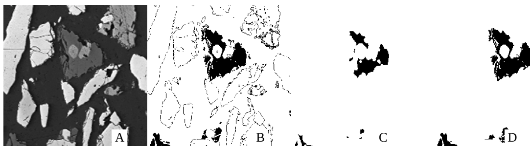
Fig. I_20. En appliquant une opération d'érosion à l'image obtenue par seuillage (B), seules les régions pertinentes sont conservées (C). La propagation de l'érodé (C) dans l'image seuillée (B) permet de reconstruire le contour exact de ces régions (D).
