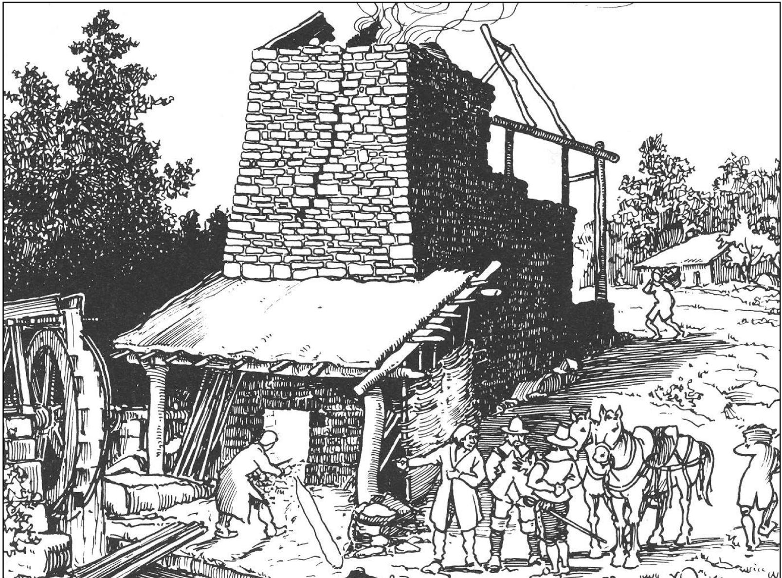
FIGURE 1.4. : haut-fourneau du XVI<sup>e</sup> siècle. Le feron, devant le fourneau, est en train de couler une gueuse de fonte dans la rigole. Notez aussi la roue à aubes actionnant le soufflet du foyer. Croquis de J. Morette (Bourguignon, 1999, p. 330) d'après le tableau de Breughel l'Ancien (l'original se trouve à la Galeria Dora Pamphilij à Rome).
