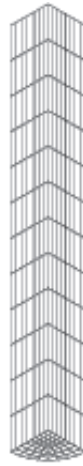
Figure 4.5: Discretisation de la barre de Taylor (12 éléments sur la hauteur et 48 éléments dans le plan).
