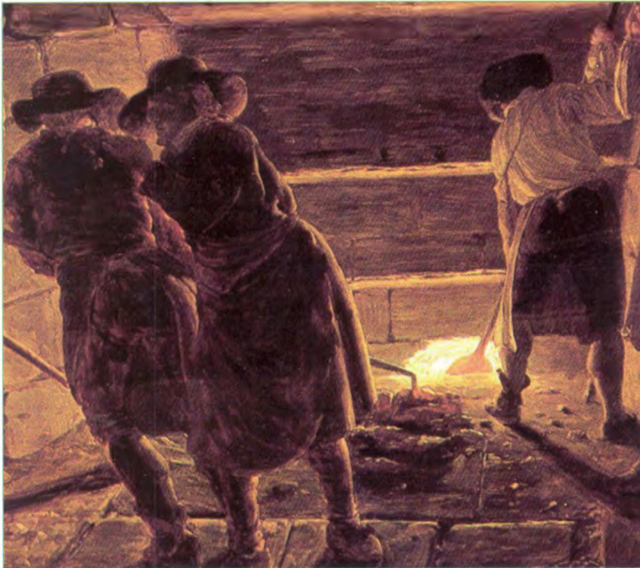
Fig. 9. Extraction de scories par écrémage de l'avant-creuset. Scène extraite d'un intérieur de fonderie peint par Léonard Defrance (coll. particulière).
