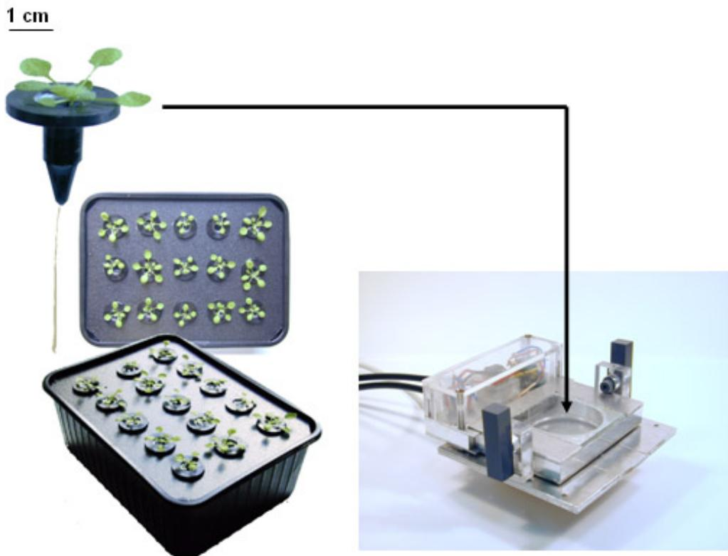
*Un équipement spécifique a été mis au point pour les besoins de la recherche: un système de culture sur milieu liquide adapté à *Arabidopsis* (à gauche) et des 'cuvettes' dans lesquelles les plantes peuvent être enfermées sans dommage pour mesurer leurs échanges gazeux avec l'atmosphère, notamment la fixation de CO<sub>2</sub> (à droite).*
