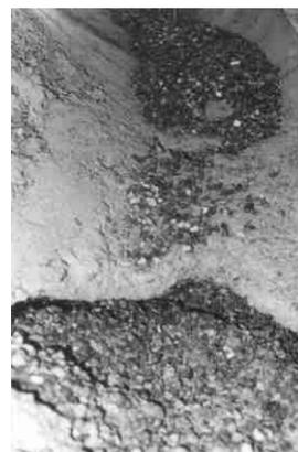
Figure 1 - Essais sur modèle réduit au Laboratoire du HACH, visant à évaluer l'impact du fonctionnement des vannes d'évacuation de crue sur le lit immédiatement à l'aval d'un barrage. La photo de droite illustre les fosses d'affouillement observées à l'issue de l'expérience.
