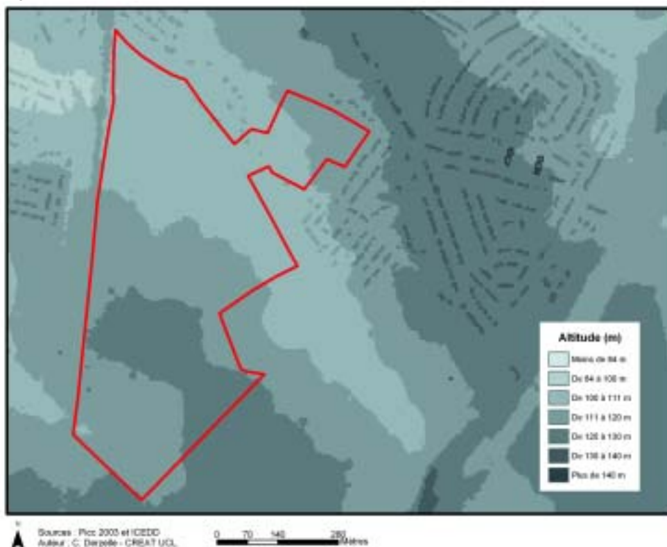
Figure 3 • Exemple de modèle numérique de terrain avec les bâtiments pris en compte
