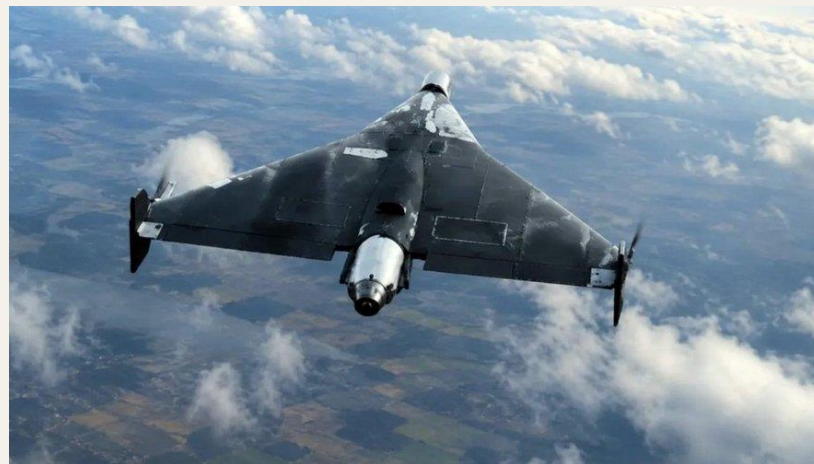
Geran-4 et Geran-5 à réaction 700 km/h (adaptation Shahed russe; 2026)
