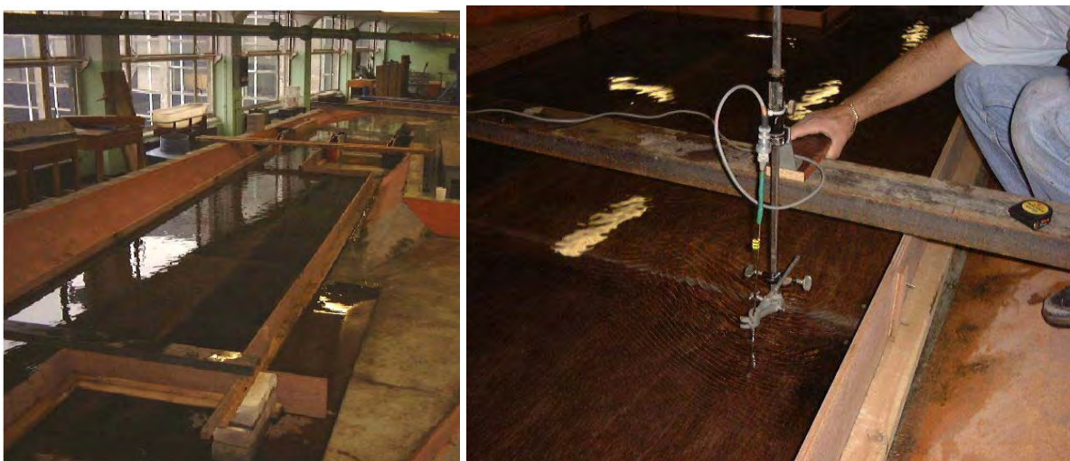
Figure 6-45 : Vue générale de l'écoulement dans le modèle et du système de mesures de vitesses par micro-moulinet
