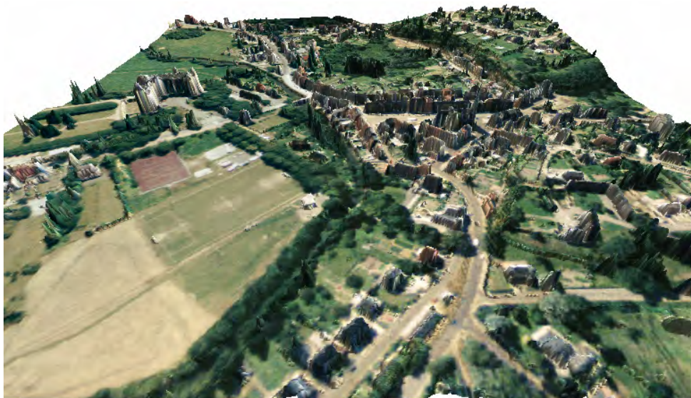
Figure 9-4 Vue 3D du village de Ham-sur-Heure, topographie laser et superposition des couleurs d'une photo aérienne
