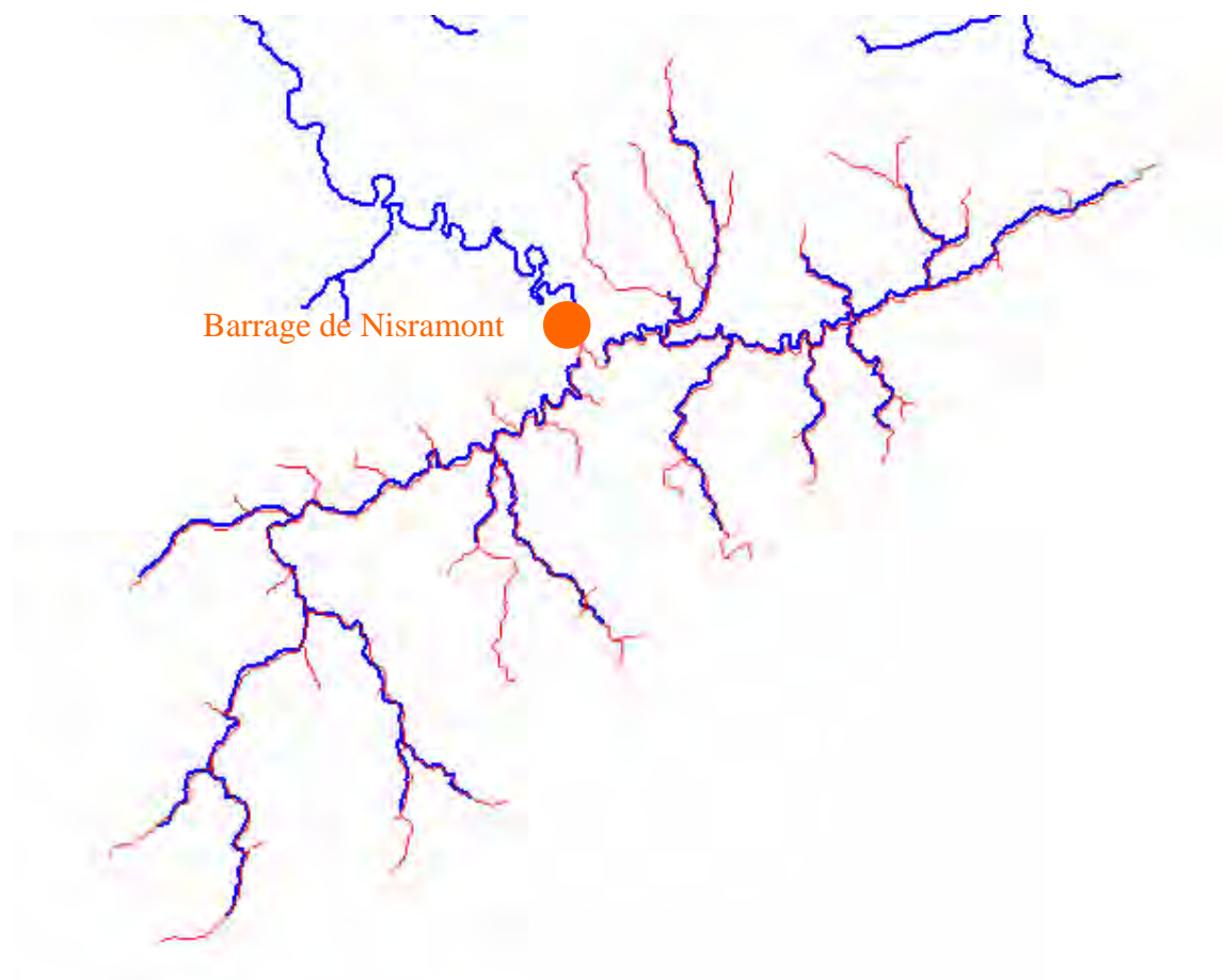
Figure 5-33 Comparaison du réseau déterminé automatiquement (rouge) et du réseau digitalisé de la région wallonne (bleu)
