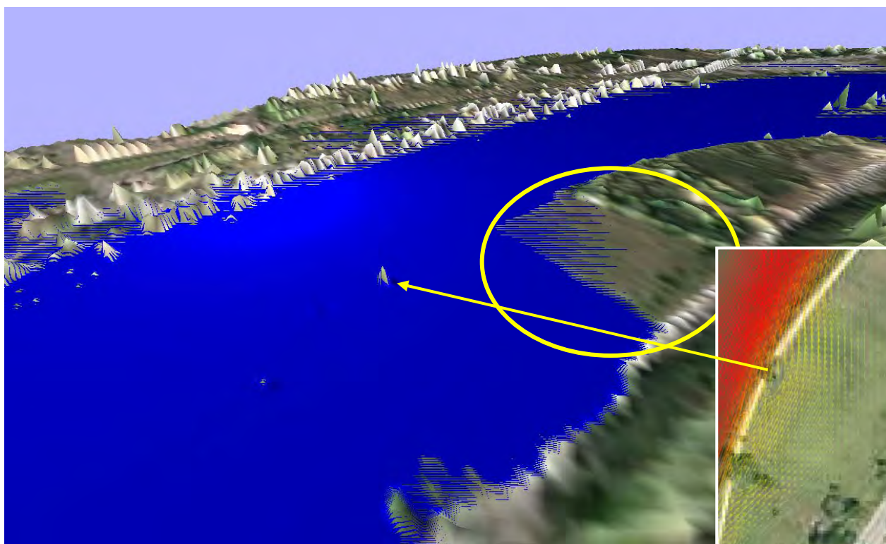
Figure 7-71 Résultat en terme d'extension d'inondation à Wanze et zoom sur la distribution des débits dans le terrain inondé (période 1993)
