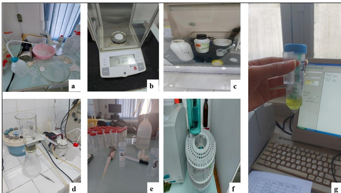
Figure 18: a : Filtration des échantillons d'eau, b : Pesage du filtre, c : Fixation des échantillons d'eau au formol, d : Filtration de l'eau fixée au formol, e : Dilution des échantillons d'eau, f : Analyse des échantillons par chromatographie ionique et g : Dosage de la biomasse chlorophyllienne par spectrophotométrie
