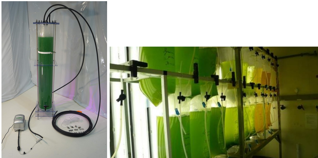
Figure 3.1 : Photo-bioréacteur (PBR) et culture en batch en sac suspendu.
